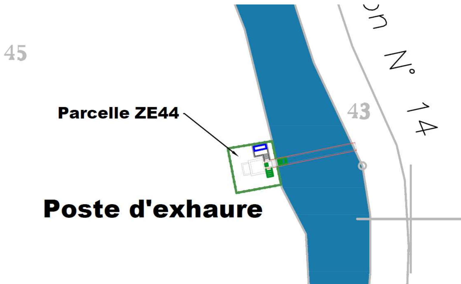
Figure 22 : Poste d'exhaure eau brute (plan projet) – zoom - Plan de masse sur fond cadastral (Véolia)
